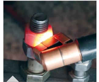
Erwärmen einer Mutter mit der Fokussierungsspule schräg
